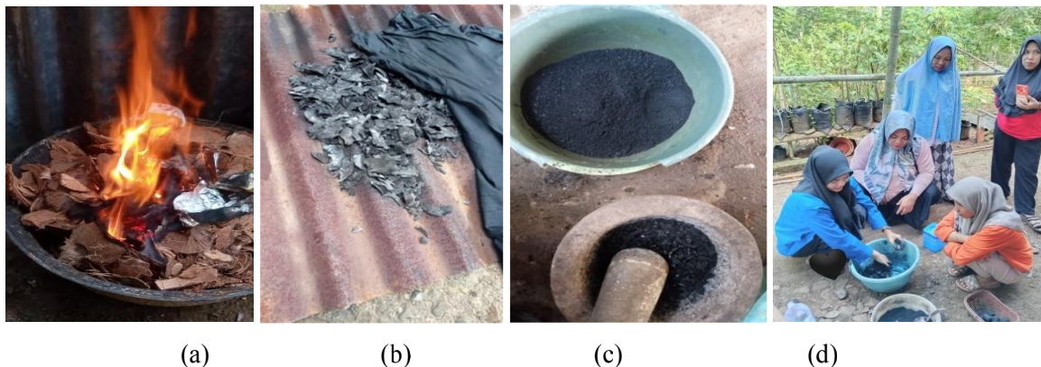
Gambar 3. Praktik pembuatan briket batok kelapa
